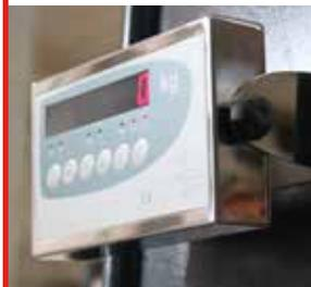
Chasis reforzado con báscula integrada, con 6 células de peso y display
