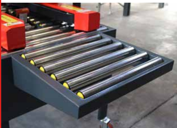
Camino de roldanas de salida/entrada
